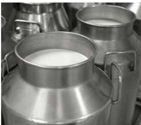
Le lait de la traite du soir arrive à la fromagerie et on le laisse reposer jusqu'au matin dans des cuves en acier spéciales à température contrôlée : pendant la nuit, le processus d'affleurement de la crème se produit. Celle-ci sera ensuite destinée à la production du beurre tandis que le lait écrémé est mélangé avec le lait entier de la traite du matin.
